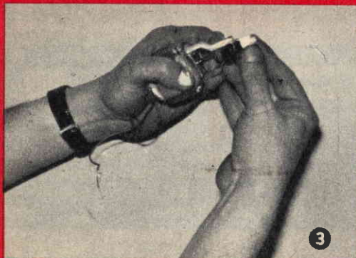
Nell'apposito foro ricavato sul ponticello metallico va introdotto l'interruttore a pulsante.
